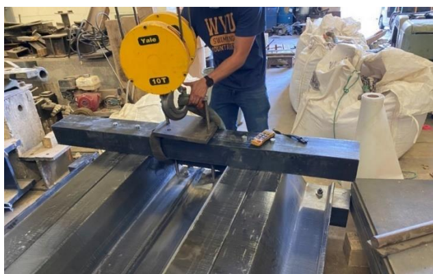
Fig. 7. Sheet pile test specimen.
